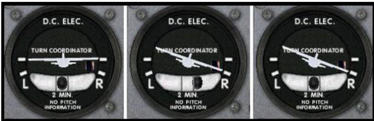
In der Grafikreihe sieht man von links nach rechts folgendes: Erst wurde geradeaus geflogen, dann eine Kurve nach rechts nur mit dem Querruder eingeleitet. Jetzt haben wir zwar die korrekte Drehrate eingenommen, aber die Kugel befindet sich weit rechts von der Mitte. Da die Regel sagt **Die Kugel treten**, treten wir mal ein wenig in das rechte Pedal und zentrieren so die Kugel wieder. Voilá, geht doch!
