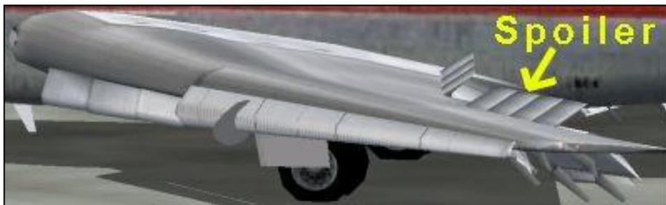
Wenn **keine** dieser **Klappen ausgefahren** sind, so ist der Flügel **sauber** oder auch **clean**. Die kleinste Geschwindigkeit, die man so fliegen kann und darf, nennt sich **Minimum Clean Speed** ( $V_{\text{minimum clean}}$ ).
