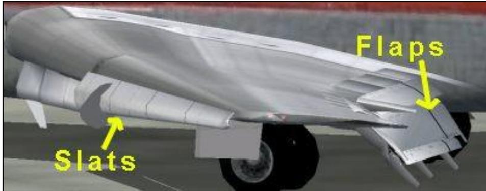
Für den Start müssen diese Klappen im Normalfall **teilweise ausgefahren** werden, um den **bestmöglichen Auftrieb** zu erzeugen. Werden sie **voll ausgefahren**, wie hier im Bild, so erzeugen sie nicht nur mehr Auftrieb, sondern ab einer gewissen Stellung auch einen höheren Widerstand, den man für den **Langsamflug** ebenfalls braucht, um im **Anflug genug Triebwerksleistung** setzen zu können und um **bei der Landung** besser abbremsen zu können.
