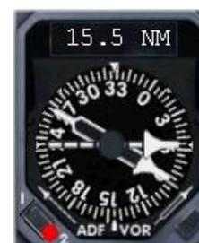
Mit einem **DME – Distance Measuring Equipment** – kann man die Distanz des Flugzeuges zu so einer Station errechnen und darstellen lassen (aufgrund der Laufzeit des Signals). Meist sind solche DME-Stationen verknüpft mit einem VOR oder ILS und senden auf derselben Frequenz.
